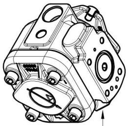
Dopo la trasformazione da un controllo pressione / portata ad un altro occorre sostituire la targhetta della pompa.
